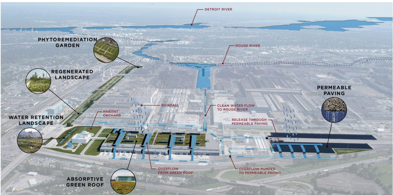
Figura 5. Il sistema di collegamento idrico tra il Ford Rouge Complex e il Rouge river.
