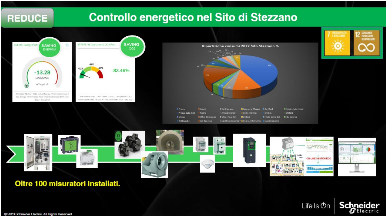
Figura 15. I misuratori e la ripartizione dei consumi per il controllo energetico del sito di Stezzano.
