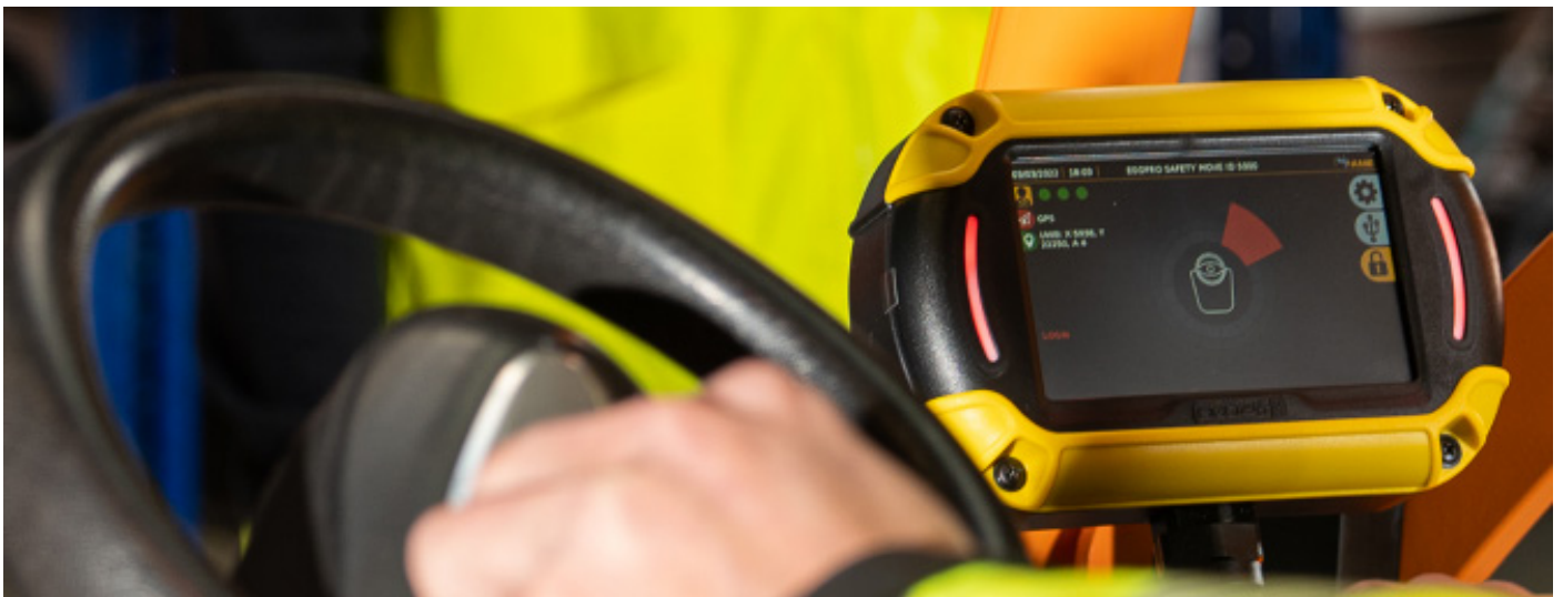
Fig.15 — Dispositivo in grado di segnalare la posizione di pedoni o altri carrelli.
