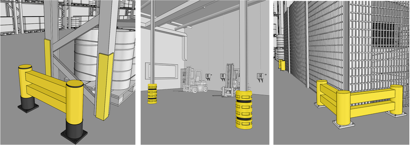
Fig. 4 Esempi di protezione installate in corrispondenza delle vie di circolazione dei carrelli elevatori
