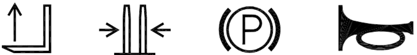
Fig. 19 — Esempi di simboli tratti dalla norma UNI ISO 3287:2006 (da sinistra, sollevamento forche, chiusura delle forche, freno di stazionamento, avvisatore acustico)
