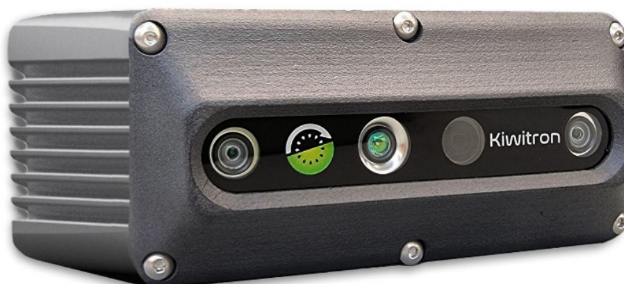
Fig.16 — Sistema di telecamere da installare sui carrelli
