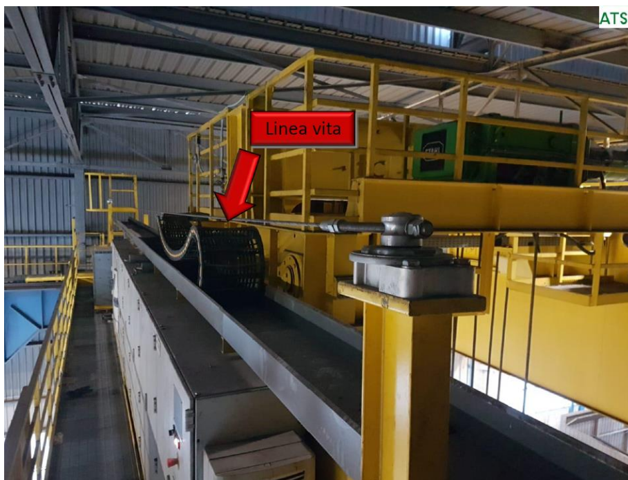
Figura 27: Linea vita montata sulla struttura del carroponete.
