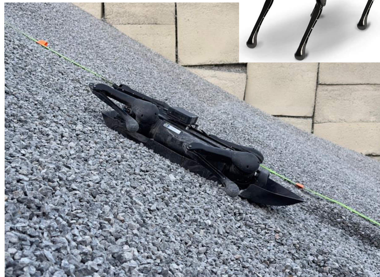
Robot Aliengo presso il sito di test sul campo con torace personalizzato e Intel Nuc 11
