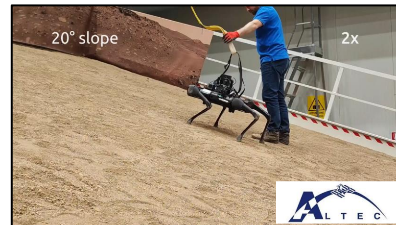
Fino a 25 gradi di inclinazione, sabbia al Mars Terrain Simulator (Altec, Italia)
