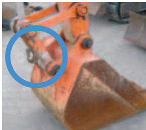
Gancio sulla biella di manovra
